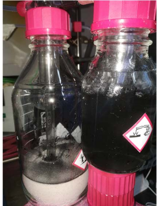
Abbildung 1: Foto der mit Wasser und Quarzsand gefüllten Flaschen zur Rückhaltung der PAK
